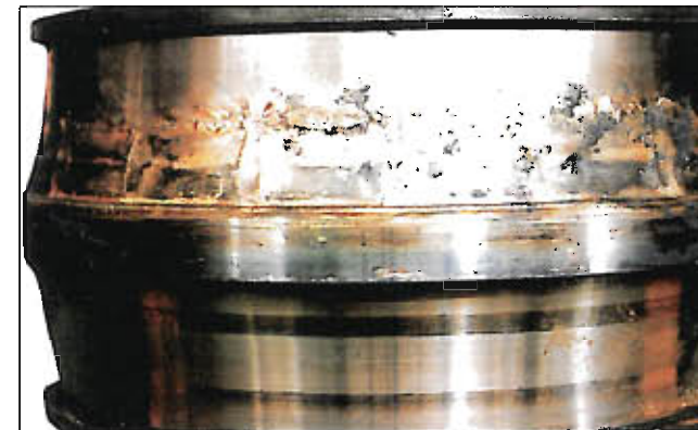
Fotografia 7-14-1 Część: Pierścień wewnętrzny łożyska baryłkowego Symptom: Bieżnia jest przebarwiona i podtopiona. Starte z kosza cząsteczki zostały wwalcowane i połączone z bieżnią Przyczyna: Niewystarczające smarowanie
