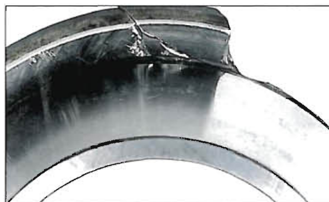
Fotografia 7-5-3 Część: Pierścień wewnętrzny łożyska baryłkowego wzdłużnego Symptom: Odlamania pojawiają się na dużym obrzeżu Przyczyna: Powtarzalne obciążenie
