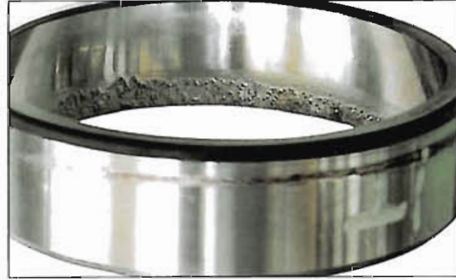
Fotografia 7-1-8 Część: Pierścień zewnętrzny łożyska z fotografii 7-1-7 Symptom: Płatkowanie tylko jednej bieżni na całym obwodzie pierścienia Przyczyna: Nadmierne obciążenie osiowe
