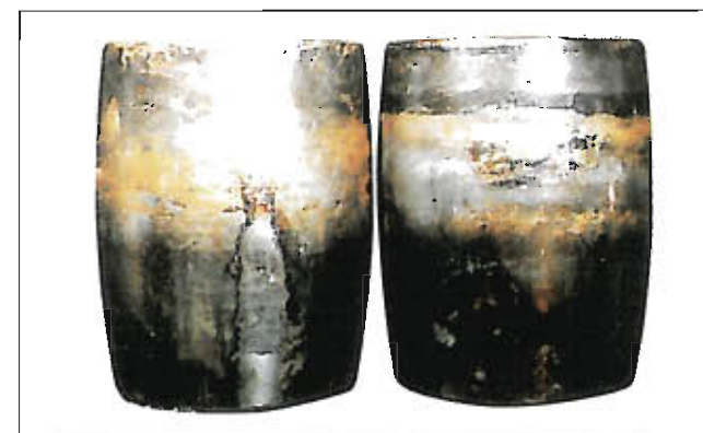
Fotografia 7-14-2 Część: Baryłki łożyska baryłkowego z fotografii 7-14-1 Symptom: Przebarwienia i stopienia powierzchni tocznej rolek, przyleganie zużytych cząsteczek kosza Przyczyna: Niewystarczające smarowanie
