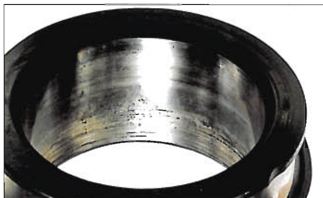
Fotografia 7-13-1 Część: Pierścień wewnętrzny łożyska baryłkowego Symptom: Pelzanie towarzyszące zatarciu powierzchni otworu Przyczyna: Niewystarczający wcisk
