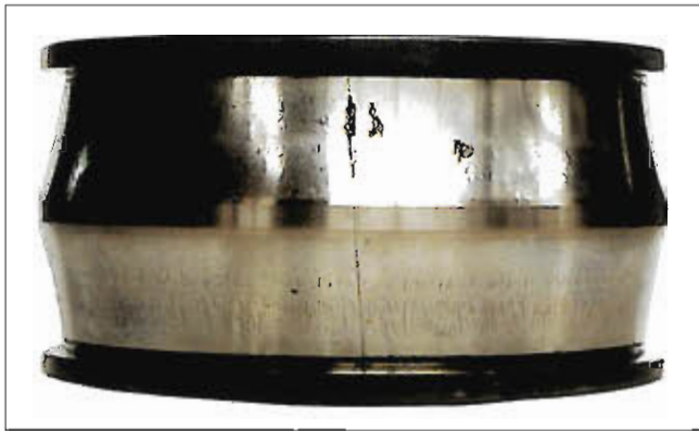
Fotografia 7-6-6 Część: Pierścień wewnętrzny łożyska baryłkowego Symptom: Pęknięcia osiowe pojawiają się na powierzchni bieżni Przyczyna: Duże napięcie pasowania z powodu różnicy temperatury między wałem i pierścieniem wewnętrznym
