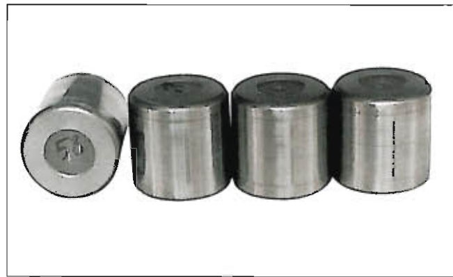
Fotografia 7-17-3 Część: Roleki łożyska walcowego Symptom: Osiowe rysy na powierzchni tocznej Przyczyna: Pochylenie między pierścieniem zewnętrznym a wewnętrznym podczas montażu.
