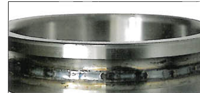
Fotografia 7-14-3 Część: Pierścień wewnętrzny łożyska kulkowego poprzecznego Symptom: Przebarwienia bieżni, stopienia pojawiają się w odstępach równych odstępom kulek Przyczyna: Nadmierne obciążenie wstępne
