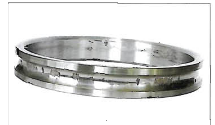
Fotografia 7-1-4 Część: Pierścień wewnętrzny łożyska kulkowego skośnego Symptom: Płatkowanie bieżni w odległości podziałowej kulek Przyczyna: Wgniecenie z powodu uderzeniowego obciążenia podczas postoju
