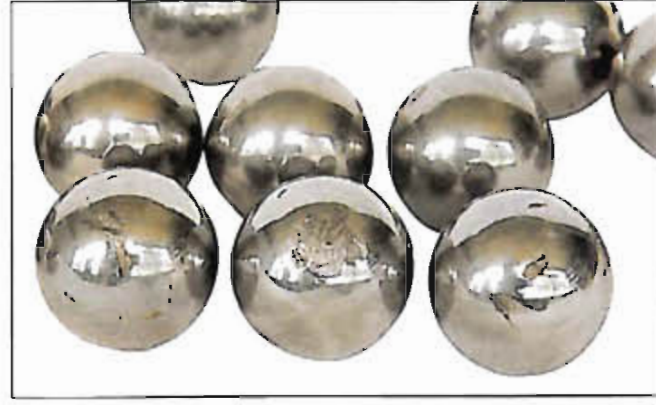
Fotografia 7-1-6 Część: Kulki łożyska z fotografii 7-1-4 Symptom: Płatkowanie powierzchni kulek Przyczyna: Wgniecenie z powodu uderowego obciążenia podczas postoju
