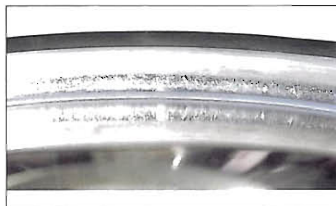
Fotografia 7-3-3 Część: Pierścień wewnętrzny łożyska stożkowego wzdłużnego Symptom: Rysy na występie czołowym pierścienia wewnętrznego Przyczyna: Zużyte cząsteczki zostały zmieszane z czynnikiem smarowym i powoduje to przerwy w warstwie oleju wskutek nadmiernego obciążenia.
