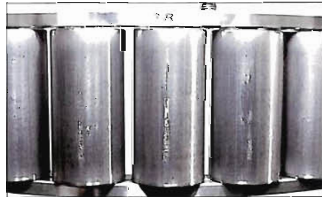
Fotografia 7-1-10 Część: Rolki łożyska walcowego Symptom: Przedwczesne płatkowanie pojawia się osiowo na powierzchniach rolek Przyczyna: Rysy powstałe podczas niewłaściwego montażu
