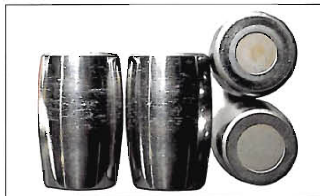
Fotografia 7-3-2 Część: Baryłki łożyska z fotografii 7-3-1 Symptom: Rysy i plamy na czołach baryłek Przyczyna: Ślizganie się rolek z powodu nagłego przyspieszenia lub opóźnienia
