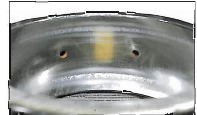
Fotografia 7-2-4 Część: Pierścień zewnętrzny łożyska baryłkowego Symptom: Złuszczenia pojawiają się na poboczu bieżni na całym obwodzie pierścienia Przyczyna: Skąpe smarowanie
