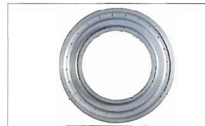
Fotografia 7-12-3 Część: Pierścień zewnętrzny łożyska kulkowego wzdłużnego Symptom: Falszywe odciski Brinella na powierzchni bieżni pojawiają się na średnicy podziałowej kulek Przyczyna: Powtarzające się drgania z małym kątem oscylacji
