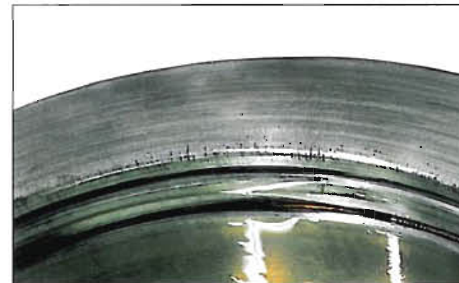
Fotografia 7-6-1 Część: Pierścień zewnętrzny łożyska walcowego dwurzędowego Symptom: Pęknięcia termiczne pojawiają się na powierzchni pierścienia zewnętrznego Przyczyna: Nadmierne ciepło generowane z powodu kontaktu ślizgowego między współpracującą częścią a czolem pierścienia zewnętrznego
