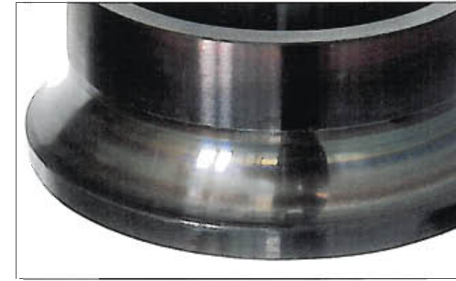
Fotografia 7-18-1 Część: Pierścień wewnętrzny łożyska kulkowego skośnego Symptom: Niebieskawe i purpurowe przebarwienia na powierzchni bieżni. Przyczyna: Wytwarzanie ciepła z powodu słabego smarowania.
