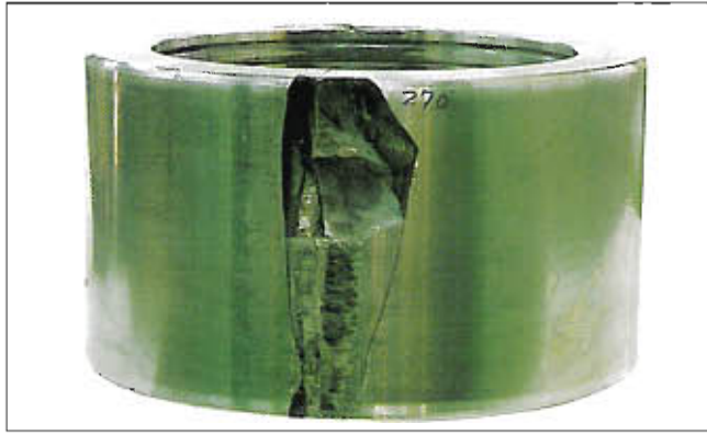
Fotografia 7-6-4 Część: Pierścień zewnętrzny łożyska walcowego dwurzędowego stosowany jako obracający się (obraca się pierścień zewnętrzny) Symptom: Pęknięcia pojawiają się na powierzchni zewnętrznej Przyczyna: Plaskie zużycie i generacja ciepła z powodu nieobracania się pierścienia zewnętrznego
