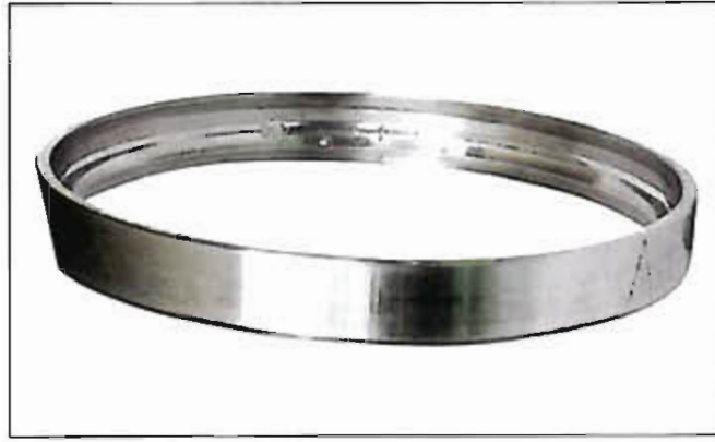
Fotografia 7-1-5 Część: Pierścień zewnętrzny łożyska z fotografii 7-1-4 Symptom: Płatkowanie bieżni w odległości podziałowej kulek Przyczyna: Wgniecenie z powodu uderowego obciążenia podczas postoju
