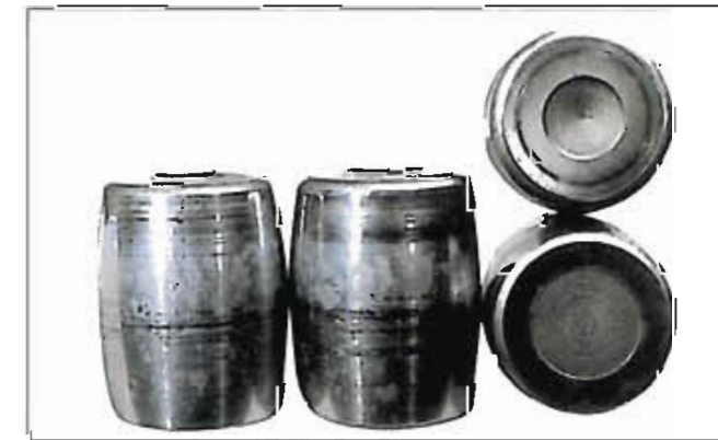
Fotografia 7-2-3 Część: Baryłki łożyska z fotografii 7-2-1 Symptom: Pojawia się wzór złuszczenia o kształcie okrągłym na środku powierzchni baryłki Przyczyna: Skąpe smarowanie
