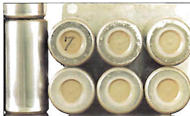
Fotografia 7-3-4 Część: Rolki łożyska walcowego dwurzędowego Symptom: Plamy na czołach rolek Przyczyna: Słabe smarowanie i nadmierne obciążenie osiowe
