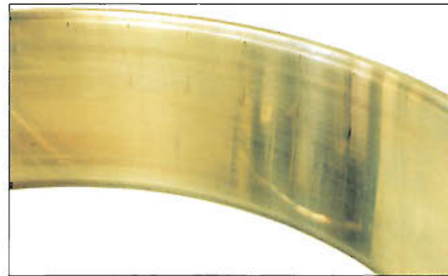
Fotografia 7-17-2 Część: Pierścień zewnętrzny dwurzędowego łożyska walcowego Symptom: Osiowe rysy na powierzchni bieżni w odstępach rolek Przyczyna: Pochylenie między pierścieniem zewnętrznym a wewnętrznym podczas montażu.
