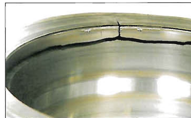
Fotografia 7-6-3 Część: Pierścień zewnętrzny łożyska walcowego dwurzędowego Symptom: Pęknięcia powiększające się na zewnątrz w kierunkach osiowym i obwodowym, a rozpoczynające się na zluszczeniach powierzchni bieżni Przyczyna: Luszczenie rozpoczynające się od skazy powstałej wskutek uderzenia
