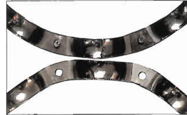
Fotografia 7-7-1 Część: Kosz łożyska kulkowego głęboko rowkowego. Symptom: Wykruszenia powierzchni kosza ze stali tłoczzonej.
