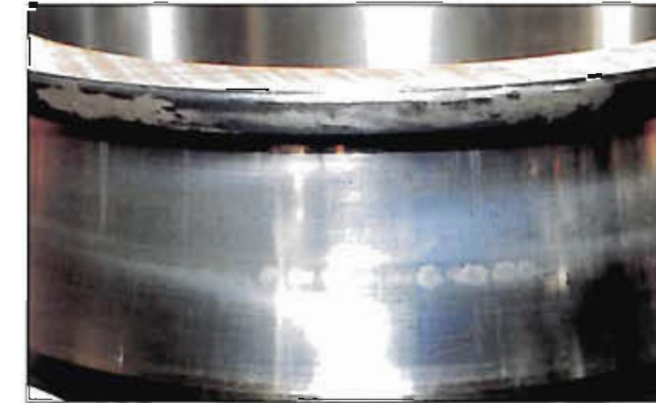
Fotografia 7-2-1 Część: Pierścień wewnętrzny łożyska baryłkowego Symptom: Pojawia się wzór złuszczenia o kształcie okrągłym na środku powierzchni bieżni Przyczyna: Skąpe smarowanie
