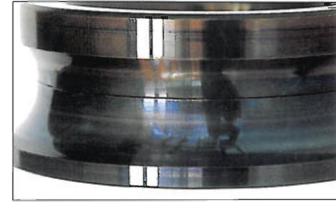
Fotografia 7-18-2 Część: Pierścień wewnętrzny łożyska kulkowego 4-stykowego Symptom: Niebieskawe i purpurowe przebarwienia na powierzchni bieżni. Przyczyna: Wytwarzanie ciepła z powodu słabego smarowania.
