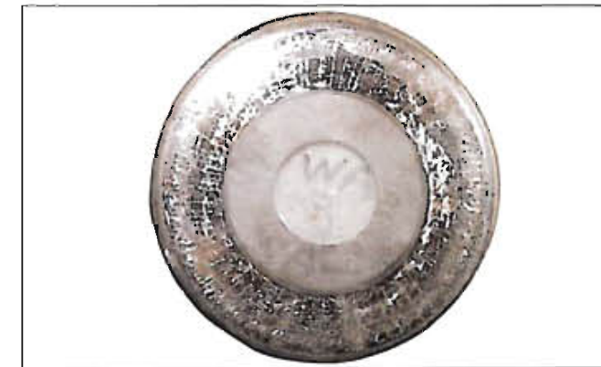
Fotografia 7-6-2 Część: Rolka łożyska stożkowego wzdłużnego Symptom: Pęknięcia termiczne pojawiają się na dużym końcu czoła rolki Przyczyna: Ciepło generowane z powodu ślizgania się po obrzeżu pierścienia wewnętrznego przy słabym smarowaniu.
