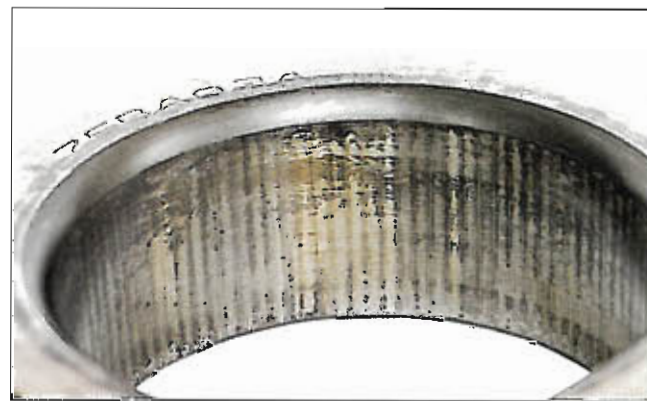
Fotografia 7-11-2 Część: Pierścień wewnętrzny łożyska kulkowego skośnego Symptom: Wyraźna korozja cierna pojawia się na całym obwodzie powierzchni otworu Przyczyna: Niewystarczające pasowanie na wcisk
