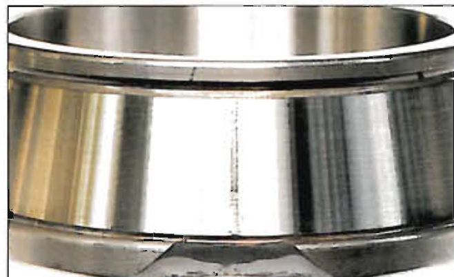
Fotografia 7-5-2 Część: Pierścień wewnętrzny łożyska stożkowego Symptom: Odlamania pojawiają się na obrzeżu prowadzącym pierścienia wewnętrznego Przyczyna: Duży uder podczas montażu
