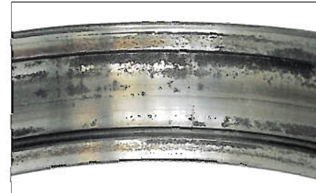
Fotografia 7-16-1 Część: Pierścień zewnętrzny łożyska walcowego. Symptom: Rdza na powierzchniach bieżni i obrzeża. Przyczyna: Niewystarczające smarowanie podczas gdy do wnętrza przedostaje się woda
