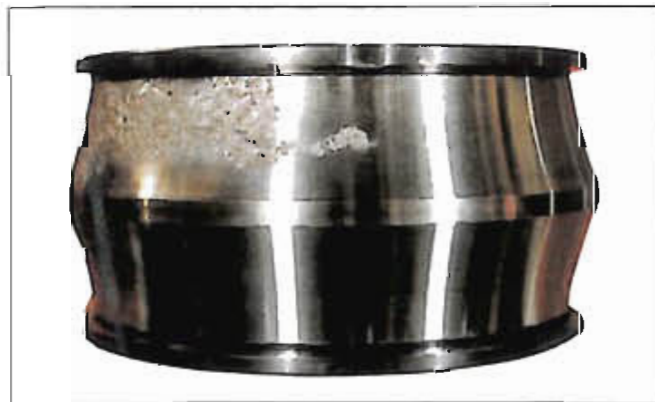
Fotografia 7-1-9 Część: Pierścień wewnętrzny łożyska baryłkowego Symptom: Płatkowanie tylko jednego rzędu bieżni Przyczyna: Złe smarowanie
