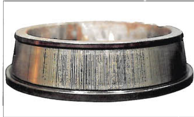
Fotografia 7-15-1 Część: Pierścień wewnętrzny łożyska stożkowego Symptom: Na powierzchni bieżni pojawia się korozja o wzorze paskowym
