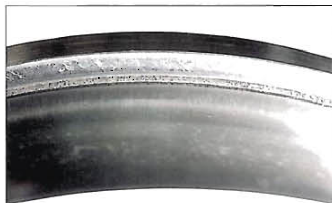
Fotografia 7-3-1 Część: Pierścień wewnętrzny łożyska baryłkowego Symptom: Rysy i plamy na dużym występie czołowym pierścienia wewnętrznego Przyczyna: Ślizganie się rolek z powodu nagłego przyspieszenia lub opóźnienia
