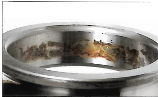
Fotografia 7-11-1 Część: Pierścień wewnętrzny łożyska kulkowego głęboko rowkowego Symptom: Korozja cierna pojawia się na powierzchni otworu Przyczyna: Drgania
