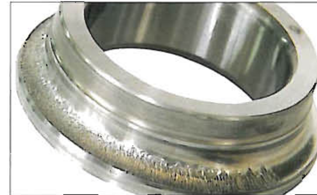
Fotografia 7-1-1 Część: Pierścień wewnętrzny łożyska kulkowego skośnego Symptom: Płatkowanie pojawia się na powierzchni bieżni na połowie obwodu pierścienia Przyczyna: Skąpe smarowanie z powodu przedostania się chłodziwa do wnętrza łożyska
