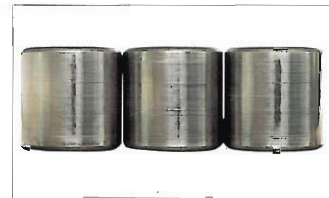
Fotografia 7-12-4 Część: Rolki łożyska walcowego Symptom: Falszywe odciski Brinella pojawiają się na powierzchni tocznej Przyczyna: Drgania z zewnętrznego źródła podczas postoju
