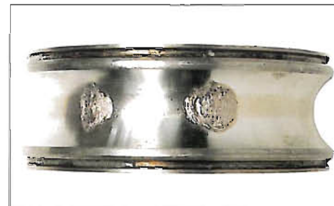
Fotografia 7-1-3 Część: Pierścień wewnętrzny łożyska kulkowego głęboko rowkowego Symptom: Płatkowanie bieżni w odległości podziałowej kulek Przyczyna: Wgniecenie z powodu uderzeniowego obciążenia podczas montażu
