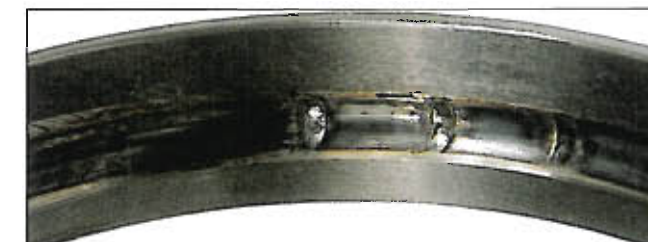
Fotografia 7-14-4 Część: Pierścień zewnętrzny łożyska z fotografii 7-14-3 Symptom: Przebarwienia bieżni, stopienia pojawiają się w odstępach równych odstępom kulek Przyczyna: Nadmierne obciążenie wstępne
