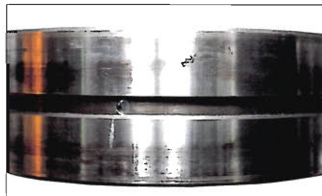
Fotografia 7-13-2 Część: Pierścień zewnętrzny łożyska baryłkowego Symptom: Pelzanie pojawiające się na całym obwodzie powierzchni zewnętrznej Przyczyna: Pasowanie suwliwe między pierścieniem zewnętrznym a obudową
