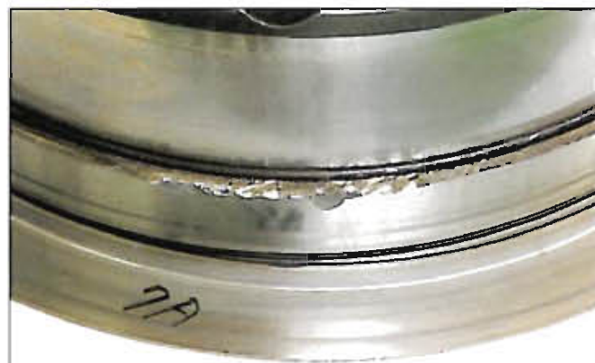
Fotografia 7-5-1 Część: Pierścień wewnętrzny łożyska walcowego dwurzędowego Symptom: Wykruszenia pojawiają się na obrzeżu środkowym Przyczyna: Nadmierne obciążenie podczas montażu
