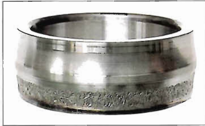
Fotografia 7-1-7 Część: Pierścień wewnętrzny łożyska baryłkowego Symptom: Płatkowanie tylko jednej bieżni na całym obwodzie pierścienia Przyczyna: Nadmierne obciążenie osiowe
