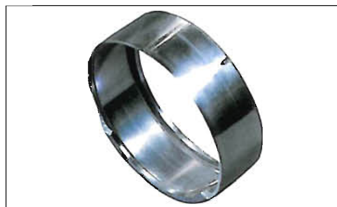
Fotografia 7-5-4 Część: Pierścień zewnętrzny łożyska igielkowego typu maszynowego Symptom: Odlamania pojawiają się na obrzeżu zewnętrznym pierścienia Przyczyna: Pochylenie igiełek z powodu nadmiernego obciążenia (Rolki igielkowe są zbyt długie w porównaniu do ich średnicy. Pod wpływem nadmiernego lub nierównomiernego obciążenia igielki są pochylane i popychane w kierunku obrzeży.)
